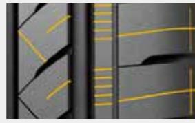
細粒溝トレッドデザインは、ウェット路面や滑りやすい路面で排水性を向上させ、ドライ路面では安定したハンドリングを実現します。
