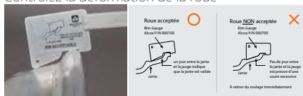
<Bride de jante déformée/usée avec bords tranchants>
