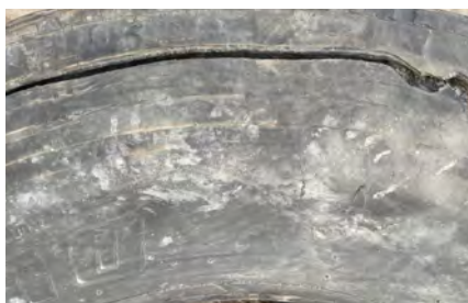
Séparation des nappes ceinture
