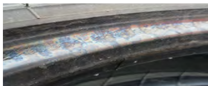
<Nombreuses craquelures sur le talon>
