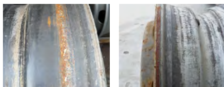
<Roue en acier corrodée>
