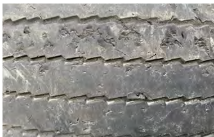
Coupures bande de roulement
