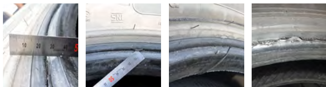
<Talon de pneumatique déformé>
