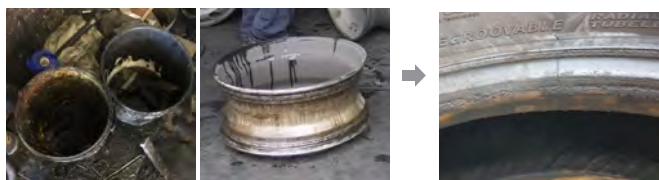
<Application d'une pâte de montage inadaptée>
