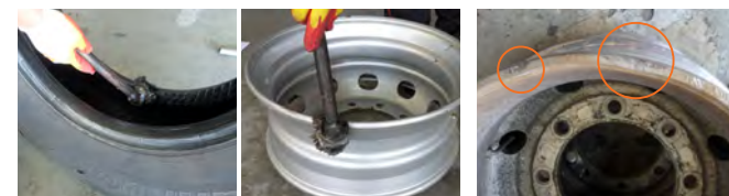
<Pâte de montage correctement appliquée>
