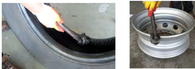
<Application de pâte de montage agréée>
