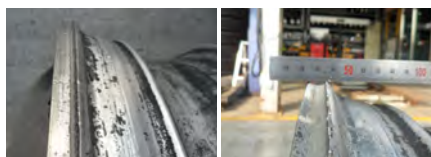
<Bride de jante déformée/usée avec bords tranchants>
