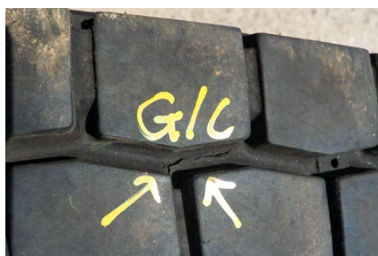
<Fissure des rainures de type 2>
