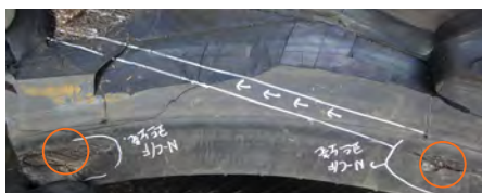
<Dommages lors des procédures de montage>
