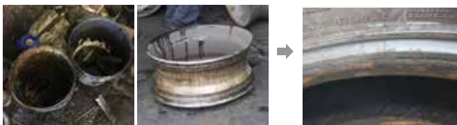
Application d'une pâte de montage inadaptée
