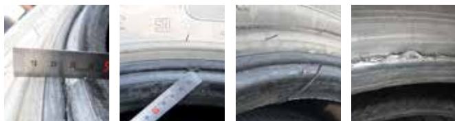
Talon de pneumatique déformé
