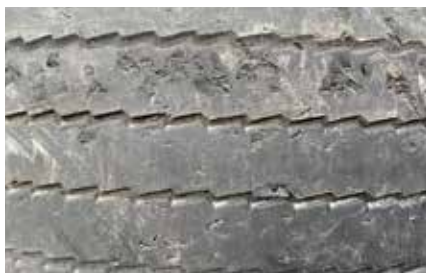
Coupures bande de roulement
