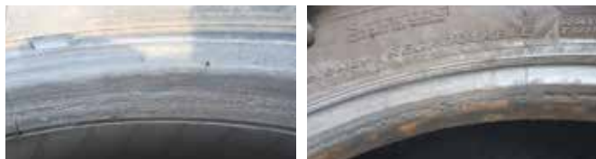
Contamination du talon par la corrosion provenant de la roue en acier
