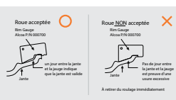
Bride de jante déformée/usée avec bords tranchants
