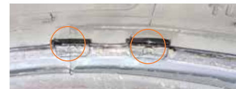
Dommages du talon du pneumatique par le clip en plomb d'équilibrage
