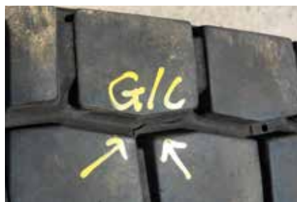
Fissure des rainures de type 2
