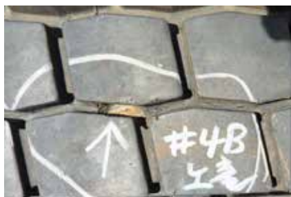
Fissure des rainures de type 1
