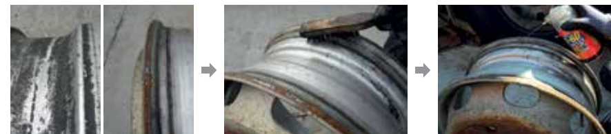
Contamination sur une roue en aluminium
